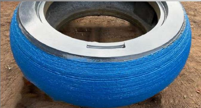
Rodillo de Pulverizador tipo Foster Wheeler
